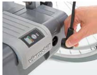
Der Stecker des Bediengerätes verbindet sich magnetisch mit dem Akku.
